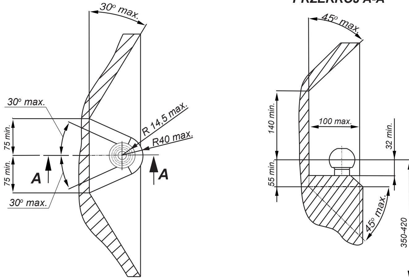
**PL** Należy zagwarantować przestrzeń swobodną według załącznika VII, rysunek 25a/b Regulaminu EKG ONZ 55.01 przy dopuszczalnym ciężarze całkowitym pojazdu.
